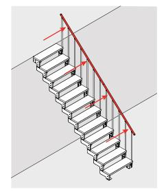
LOAD ON HANDRAIL Max. 0,5 kN/m ~ 50 kg/m
